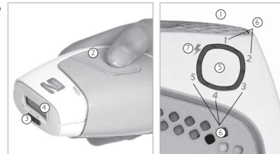
EL APARATO DE DEPILACIÓN Silk'n Flash&Go™ tiene una SUPERFICIE DE TRATAMIENTO, un PANEL DE CONTROL y un GATILLO DE PULSOS.
