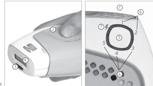
Sur l'appareil d'épilation, vous localiserez la touche de commande Flash&Go™ qui inclut un bouton central qui constitue également le bouton de réglage du niveau d'énergie, ainsi que les voyants lumineux de MARCHE, du niveau d'énergie, Prêt, et d'avertissement système
